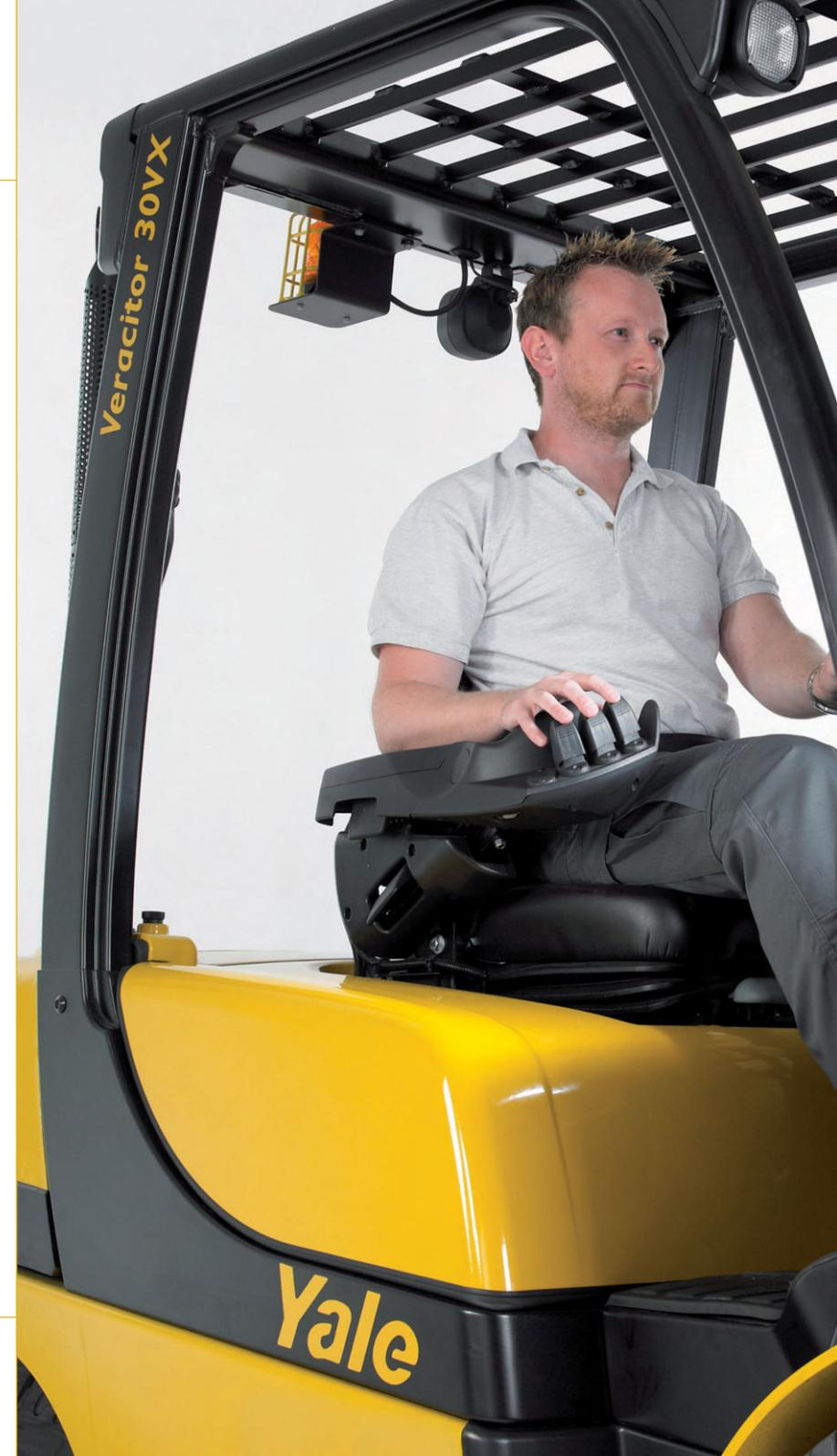
Die niedrige Tritthöhe erlaubt ein einfaches Ein- und Aussteigen. Auch die manuellen Hydraulikhebel, die serienmäßig an der Frontseite montiert sind, behindern das Zusteigen und Aussteigen auf der rechten Seite nicht.
