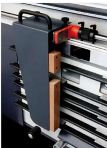
Der stabile, klappbare Längenanschlag (mit Feineinstellung) wird auf einer 30mm massiven Rundstange geführt. Optional kann eine Anschlagverlängerung eingesetzt werden. Hierdurch müssen schwere Werkstücke nicht auf die Mittelauflage gestellt werden, damit sie an den Anschlag heranreichen.
