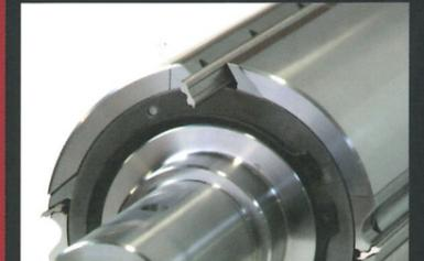
OPTION: 2 Tischwalzen: optimaler Transport von nassem Holz
