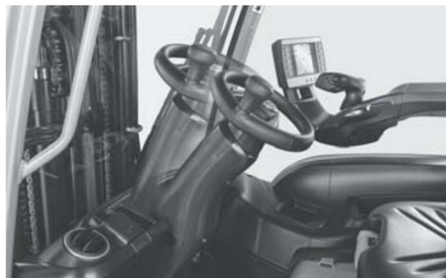
Réglage en hauteur de la colonne de direction depuis le siège conducteur
