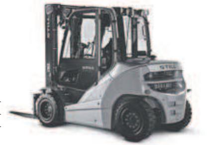
Die verbrennungsmotorischen Stapler RX 70-40/50 mit einer Tragfähigkeit bis 5 Tonnen sind mit dieselektrischem Antrieb ausgestattet. Dieser kombiniert die Vorteile des kraftvollen Verbrennungsmotors mit der exakten Regelbarkeit eines Elektroantriebs. Das garantiert eine hohe Verfügbarkeit und verlängerte Einsatzdauer bei niedrigeren Betriebskosten. Durch ihre kompakte Bauweise und hohe Wendigkeit, gepaart mit feinfühligem Fahr- und Hubsteuerung, lässt sich eine hohe Umschlagleistung erzielen.
