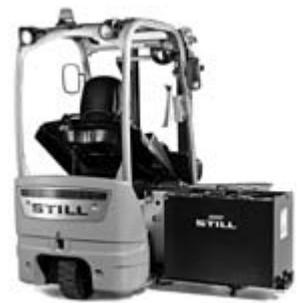
4) Puente de batería a bordo para el cambio con grúa
