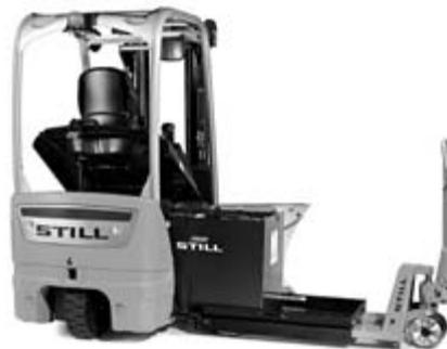
3) Cambio con transpaletas estándares, Transpaletas eléctricas y bastidor intercambiable de batería
