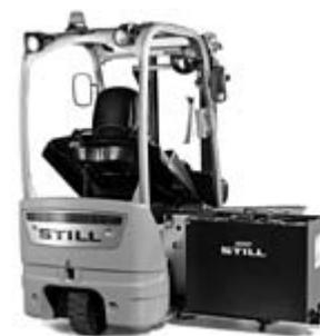
4) Plate-forme sur roulettes pour remplacement par élingage.
